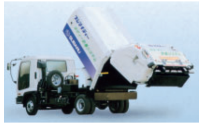
国内初となるダンプ排出式塵芥収集車への自重計量システムの採用
