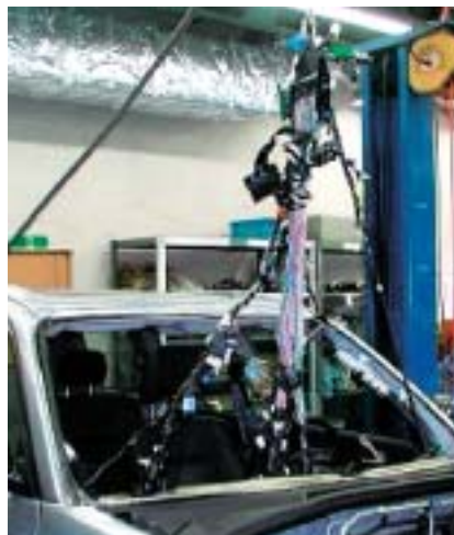
写真1：ワイヤリングハーネスの取り外し実験の様子
