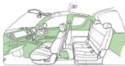
緑：統合材の使用部位
