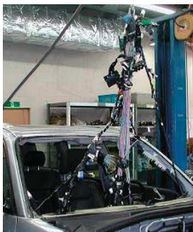
ワイヤリングハーネス類の解体性向上。
