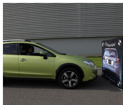
ステレオカメラを用いた先進運転支援システムの「EyeSight」。
