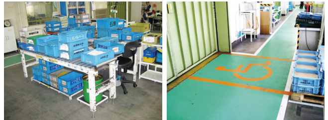
職場内にある自動扉のスイッチや作業台は、車いすの従業員に合わせた高さに設定しています。
