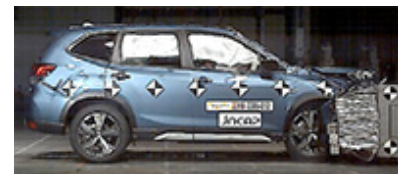
フォレスターのJNCAP※オフセット前突試験画像提供：自動車事故対策機構
