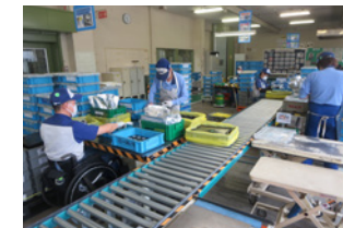
職場内にある作業台は、車いすの従業員に合わせた高さで設定
