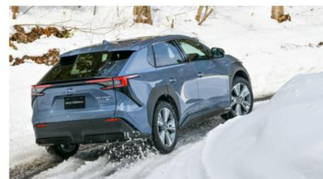
BEVならではのAWDシステムとして、前輪と後輪をそれぞれ別のモーターで駆動する新システムを採用しました。長年蓄積してきた4つのタイヤを緻密に制御するSUBARUの技術と、モーターだから可能になった高い応答性や自在な前後駆動力配分を活かし、4輪のグリップ力を最大限に使った安心感の高い走りを実現しました。
